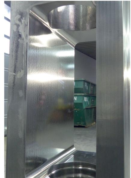
**Glatt erledigt:** Der Fräser erzeugte an diesen zylindrischen Wangen aus GGG 70 über eine Länge von 300 mm eine polierähnliche Oberflächengüte © Pokolm
